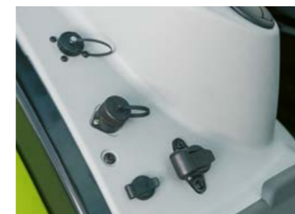
Conexiones ISOBUS en la cabina y en la parte trasera.
