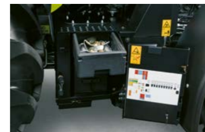
NUEVO: A la derecha del acceso se encuentra muy a mano la batería, el espacio para las herramientas y una conexión de aire comprimido.
