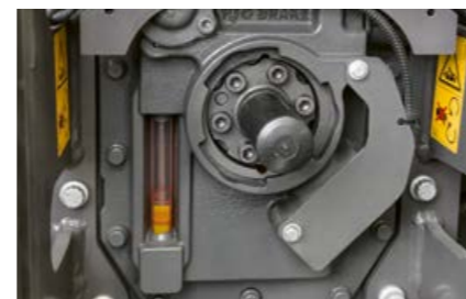
Usted controla el nivel de aceite de los engranajes y la instalación hidráulica con un cristal de observación junto a la toma de fuerza.
