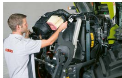
El filtro de aire del motor está montado delante de los radiadores y se deja limpiar fácilmente.
