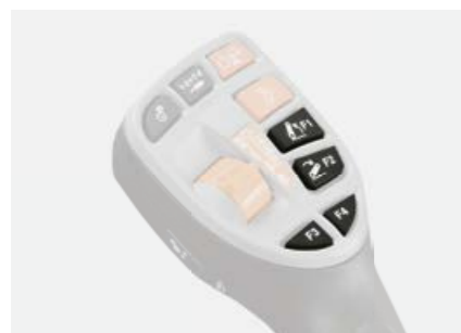
Activación de hasta cuatro funciones ISOBUS directamente con las teclas funcionales del mando multifuncional.
